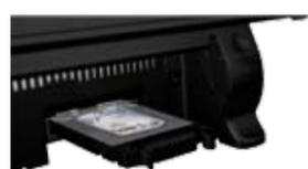
Come per tutti i sistemi Axon POS, anche in questo caso abbiamo prestato una particolare attenzione alle necessità di manutenzione del disco rigido. Axon POS 2400 integra il disco rigido in una posizione a cui è possibile accedere immediatamente per estrarre rapidamente l'hard disk dall'alloggiamento, il tutto senza l'utilizzo di alcun attrezzo.
